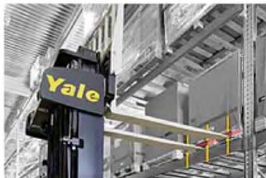
забора грузов на значительной высоте. Лазер включается автоматически, когда высота подъема вил превышает высоту свободного подъема (около 2 м).
