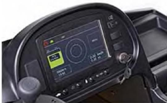
Впервые примененный в отрасли дисплей с расширенными функциями и сенсорным экраном позволяет операторам в любой момент полностью контролировать все функции ричтрака. В дисплее с сенсорным экраном предусмотрены следующие функции: доступ с помощью PIN-кода, предварительный выбор высоты, данные системы управления парком погрузчиков, индикация массы груза, ручная коррекция прерывания подъема, выбор малого хода. Предусмотрена
